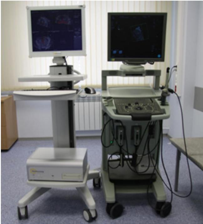
Рис. 1. Ультразвуковая компьютер-ассистированная система гистосканирования
